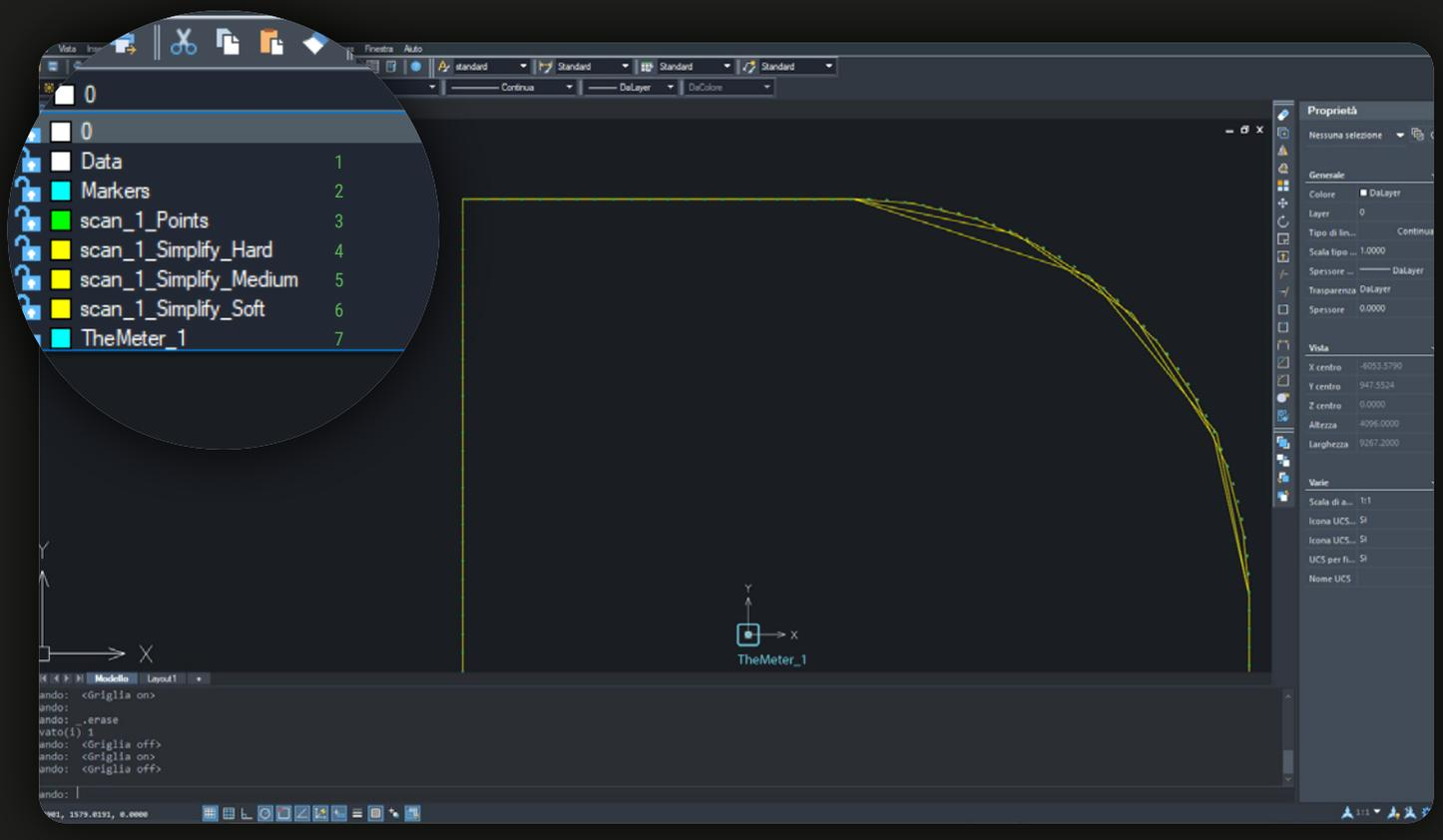
Inoltre trovi la scansione per punti in "Points"<sup>3</sup> e in tre semplificazioni in polilinea nei livelli Simplify "Hard"<sup>4</sup>, "Medium"<sup>5</sup> o "Soft"<sup>6</sup>, in base a cosa avrai scelto di esportare; il livello "TheMeter"<sup>7</sup> indica la posizione del **CUBE**
