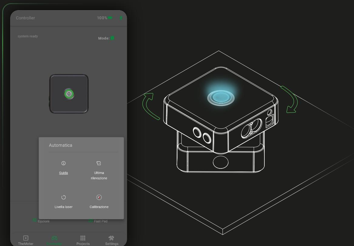
Il dispositivo inizierà un test per verificare la calibrazione attuale della bussola, ruotando la testa di 360° in 4 step; Il procedimento sarà accompagnato dal segnale led azzurro fisso quando è in movimento e lampeggiante tra uno step e l'altro
